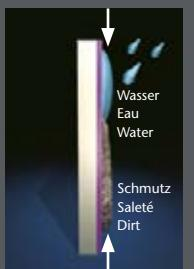
Wassertropfen setzen sich auf HT-veredelte Fliese und verbinden sich zu einem gleichmäßigen Wasserfilm, ...
